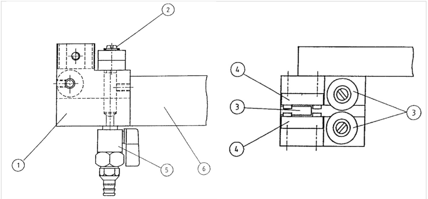
*Сборочный чертеж:* Узел твердосплавных направляющих ленточной пилы (УТНВ 220)
